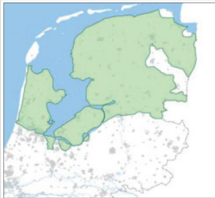
Indicatie van het gebied dat onder normale omstandigheden van water kan worden voorzien uit het IJsselmeer, Markermeer en de Randmeren. Uit Synthesedocument IJsselmeergebied, RWS 2014)
